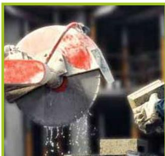
Tronçonneuse avec système d'abattage à l'humide - bordures
