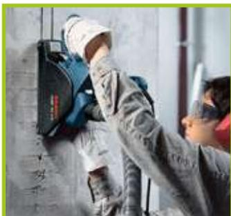
Rainureuse à béton avec système d'aspiration
